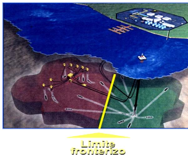
Fig. 7. Esquema simplificado de Unitización
